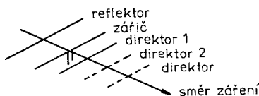
Obr. 198. Víceprvková anténa typu YAGI
