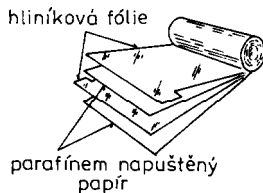
Obr. 19. Svitkový kondenzátor s papírovým dielektrikem
