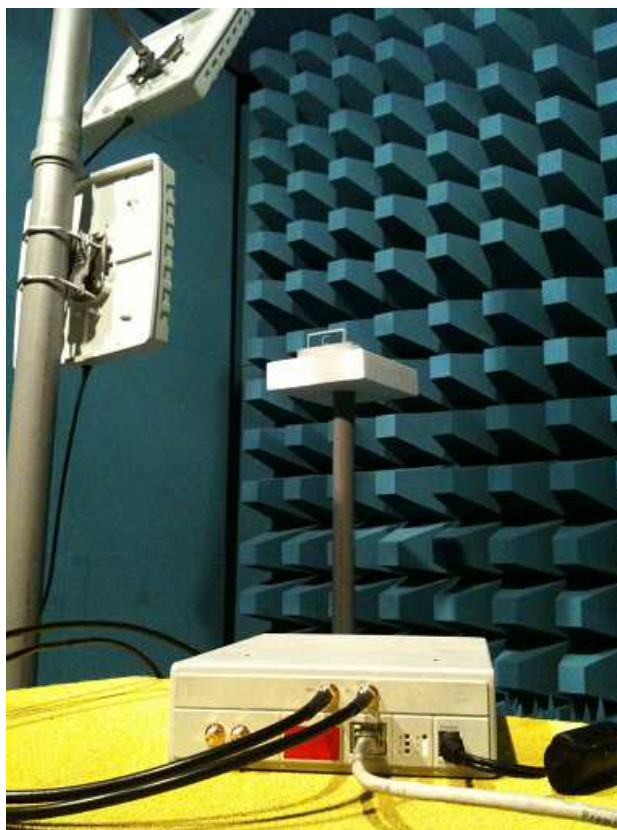
Obr. 1: Systémová konfigurace v RF komoře se základní testovací jednotkou
