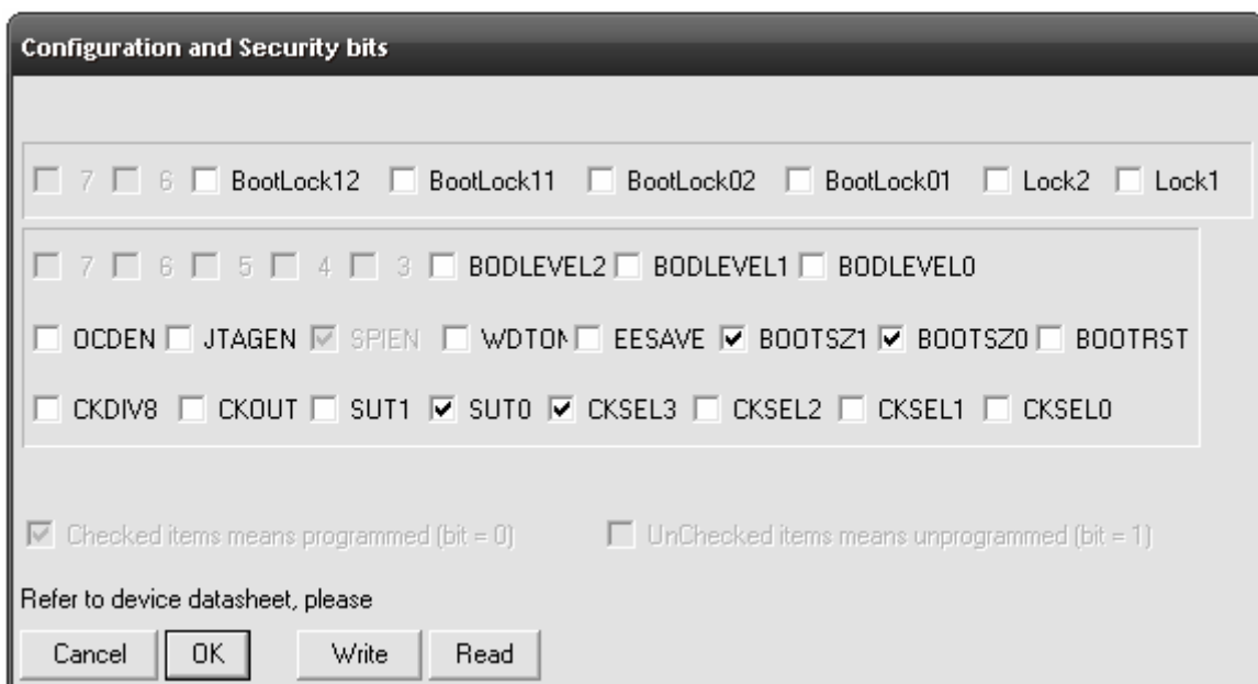
Obr. 16: nastavení bezpečnostních a konfiguračních zámků v programu Pony Prog
