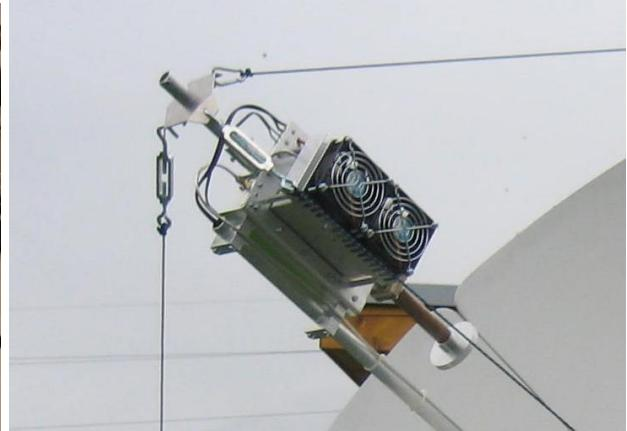
Obr. 16. SSPA, LNA a WR75 přepínač v ohnísku.
