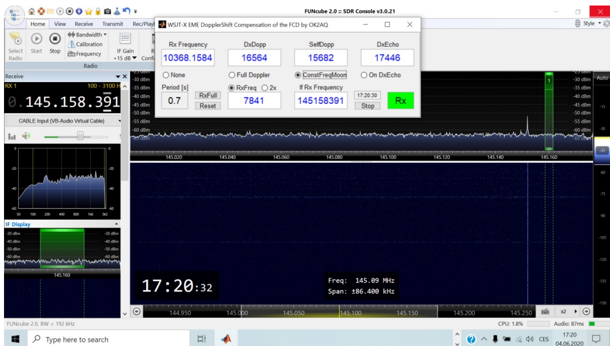
Obr. 1. SDR Console s DoppAQSDR pro kompenzaci Dopplerova posuvu.
