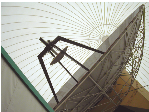
Obr. 2. Pod kopulí je teleskop s Cassegrainovým uspořádáním
