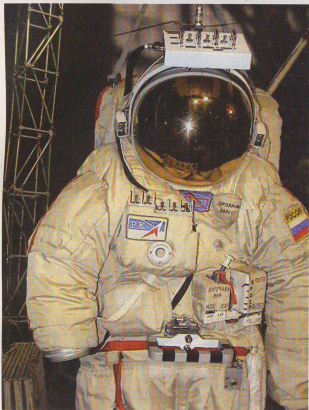
Obr. 1. Družice SuitSat-1: skafandr ORLAN bez kosmonauta, vybavený ale pro rádiovou komunikaci a madlem (v pase) pro uchopení
