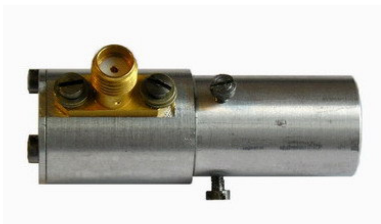
Obr. 2.7: Fotografie zkonstruovaného ozářovače
