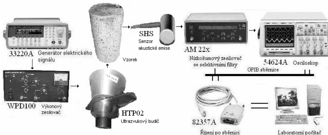
Obr. 1: Blokové schéma měřící aparatury pro nelineární ultrazvukovou spektroskopii.
