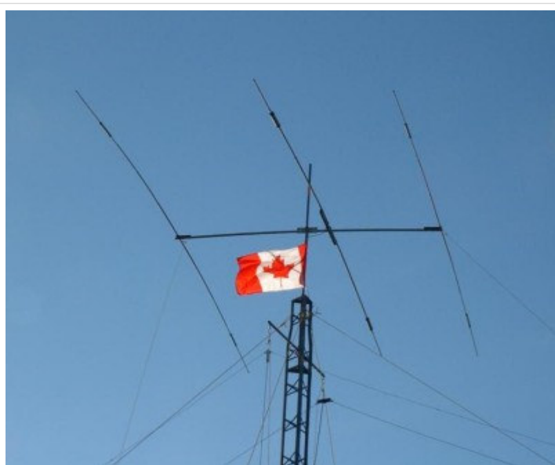
Obr. 10.7A.1 Praktická realizace Yagiho antény
